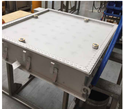
Fig. 6 – Manhålslucka fylld av kunden/förberett för påfyllning på plats
